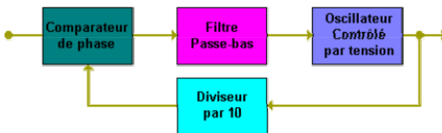
FIGURE 5 : Multiplicateur de fréquence basé sur une boucle de réaction à verrouillage de phase.
